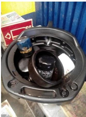
**Figura 4. Filtros de aceite en posición vertical**
